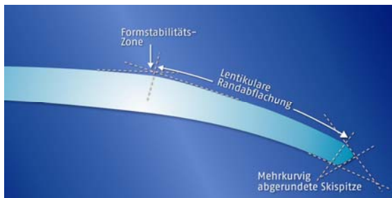
Schnitt durch die Linsenperipherie der Contaview premium UV
